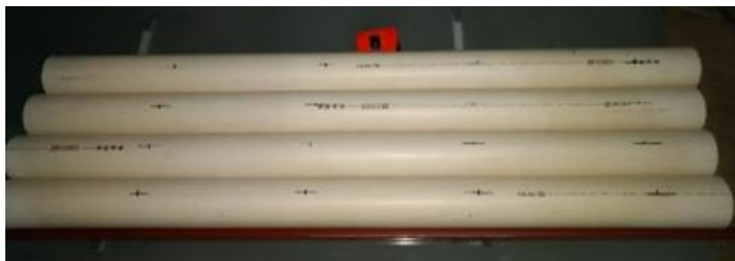
Figura 65. Tubos de esgoto \varnothing = 75 mm para servir de canais de cultivo, com as devidas marcas a cada 25 cm. Fonte: foto dos autores.
