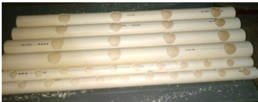
Figura 67. Canais de cultivo final e de mudas com a furação final. Fonte: foto dos autores.
