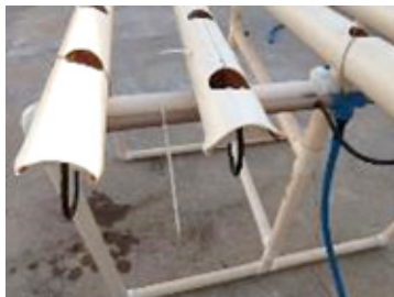
Figura 75. Detalhe da posição do barrilete e dos microtubos. Fonte: foto dos autores.
