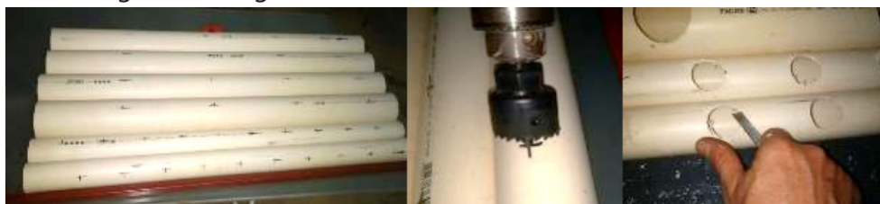
Figura 66. Tubos de esgoto \varnothing = 75 mm para servir de canal de berçário para as mudas marcados a cada 10 cm (esquerda), detalhe da furação com serra copo (centro), retirada das rebarbas de PVC (direita). Fonte: fotos dos autores.
