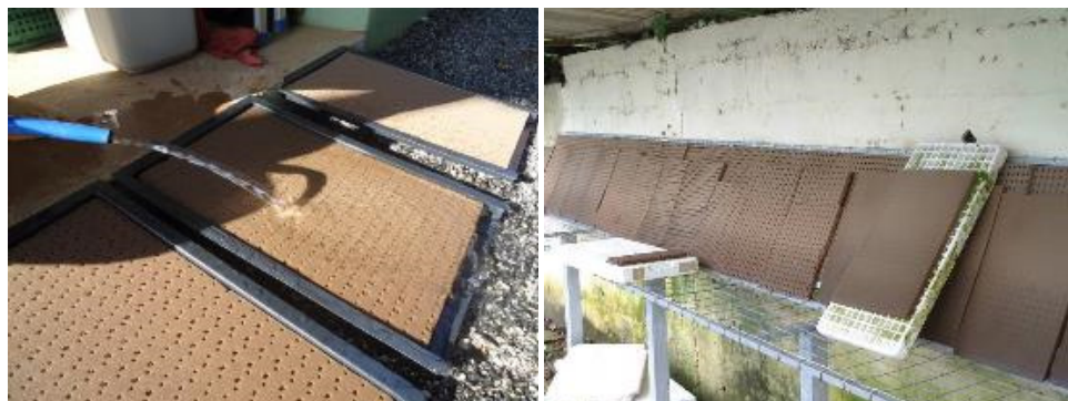
Figura 44. Lavagem da espuma fenólica. Fonte: fotos dos autores.
