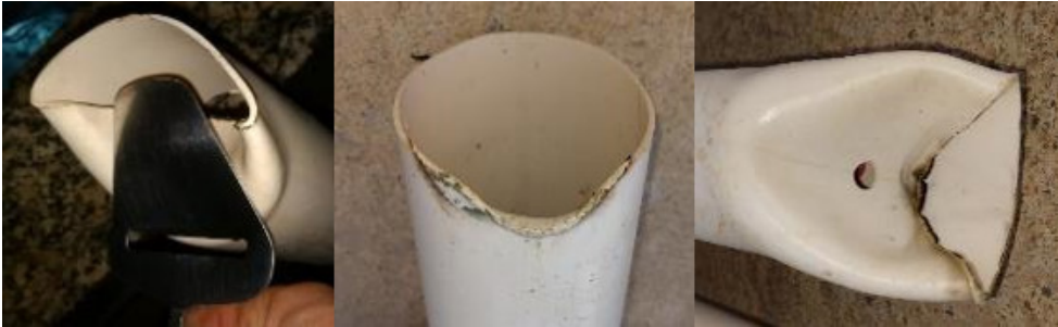
Figura 68. Detalhe do início do canal (esquerda) e pingador do final (direita). Fonte: ilustração e fotos dos autores.
