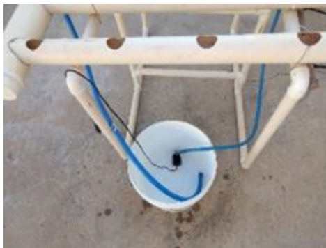
Figura 76. Montagem do reservatório e da bomba.
